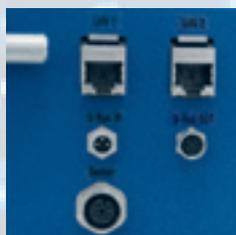
*Neben den beiden Ethernet-Anschlüssen, können die gewünschten Schnittstellen auf die Front gezogen werden. Hier zwei M8-Buchsen zum Auslesen der Energiezähler, und eine M12-Buchse für den Anschluss eines Temperatur-Sensors.*
